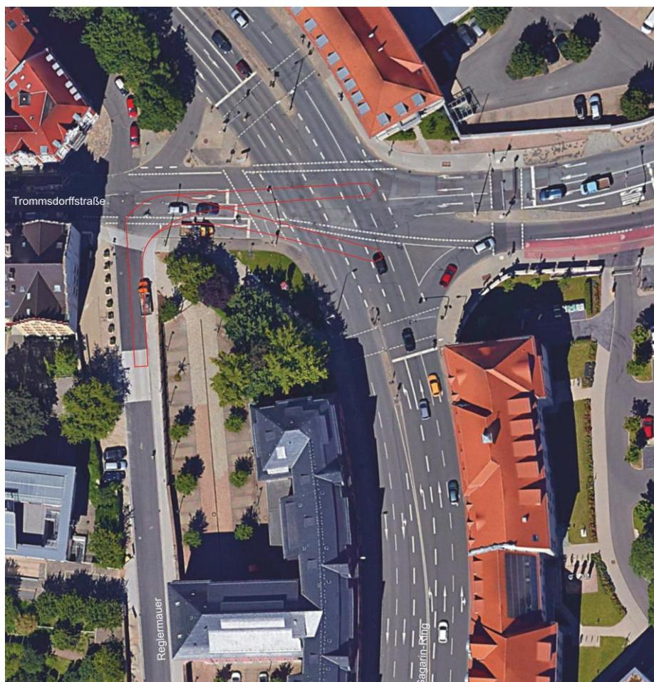
Abbildung 15: Schleppkurve Lastzug (Fw2-stehend; eigene Darstellung)
