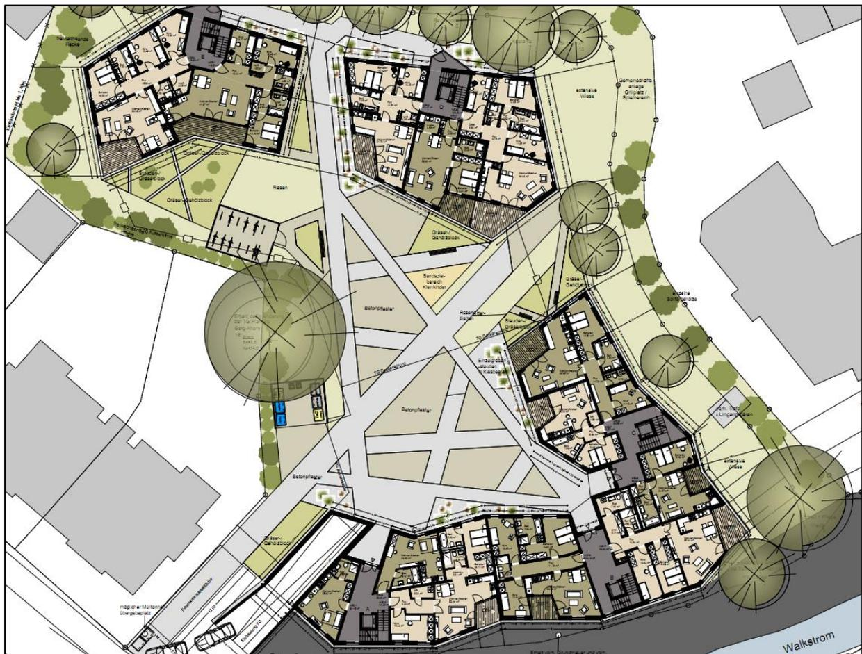
Abb. 4.2: Lageplan des Erdgeschosses mit Lage der geplanten Wohnungen (farbig verschieden gekennzeichnet). Kartengrundlage: vom Auftraggeber
