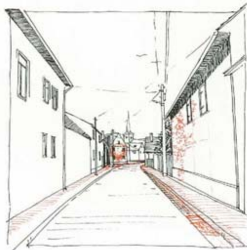
BETONUNG DER RAUMLICHEN AUFWEITUNG DURCH KLEIN- RUNDEN LAUBEN KLEINFELDES TRAKUPFLASTER (NATURSTEIN) AN DER SÜDSEITE (ANSTRICH - ASPHALT MIT HELLEM EINGESTREUPLIT) (RINNE ALS SLANGRÄHNEN SCHLACKESTREIFEN O. FISCHEN) FUßWEG: DURCH TREFKORD ANGESCHÜTZT (SPANIT ODER BETONSTEIN)
