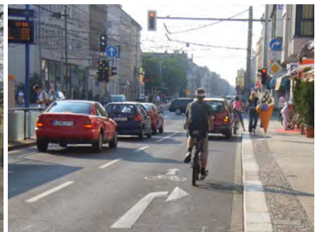
Beispiel Leipzig Kombinierter Fahrstreifen für rechtsabbiegende Kfz und geradeausfahrenden Radverkehr bei engen Platzverhältnissen
