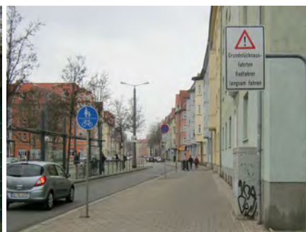
Leipziger Straße Bei ausreichend Platz Rad- und Gehweg an den Zufahrten durch deutliche Kennzeichnung Radverkehr klar trennen.
