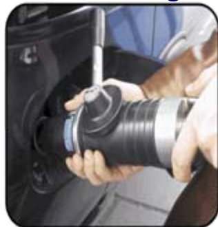
2. Tankkupplung auf Ventil an- setzen, verriegeln
