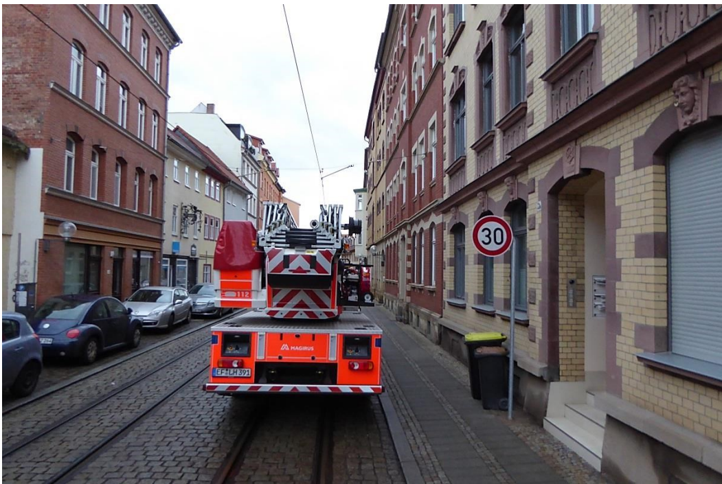
Abb. 27 – Behinderung durch Oberleitungen und Abspannungen
