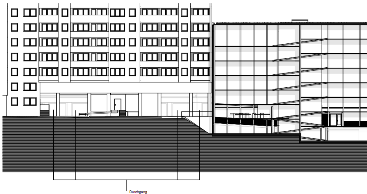
Abb. 4.2: Schnitt zur schematischen Darstellung der durchströmbaren Bereiche (= Durchgang) in der Wohnscheibe Juri-Gagarin-Ring 9, Skizze ohne Maßstab
