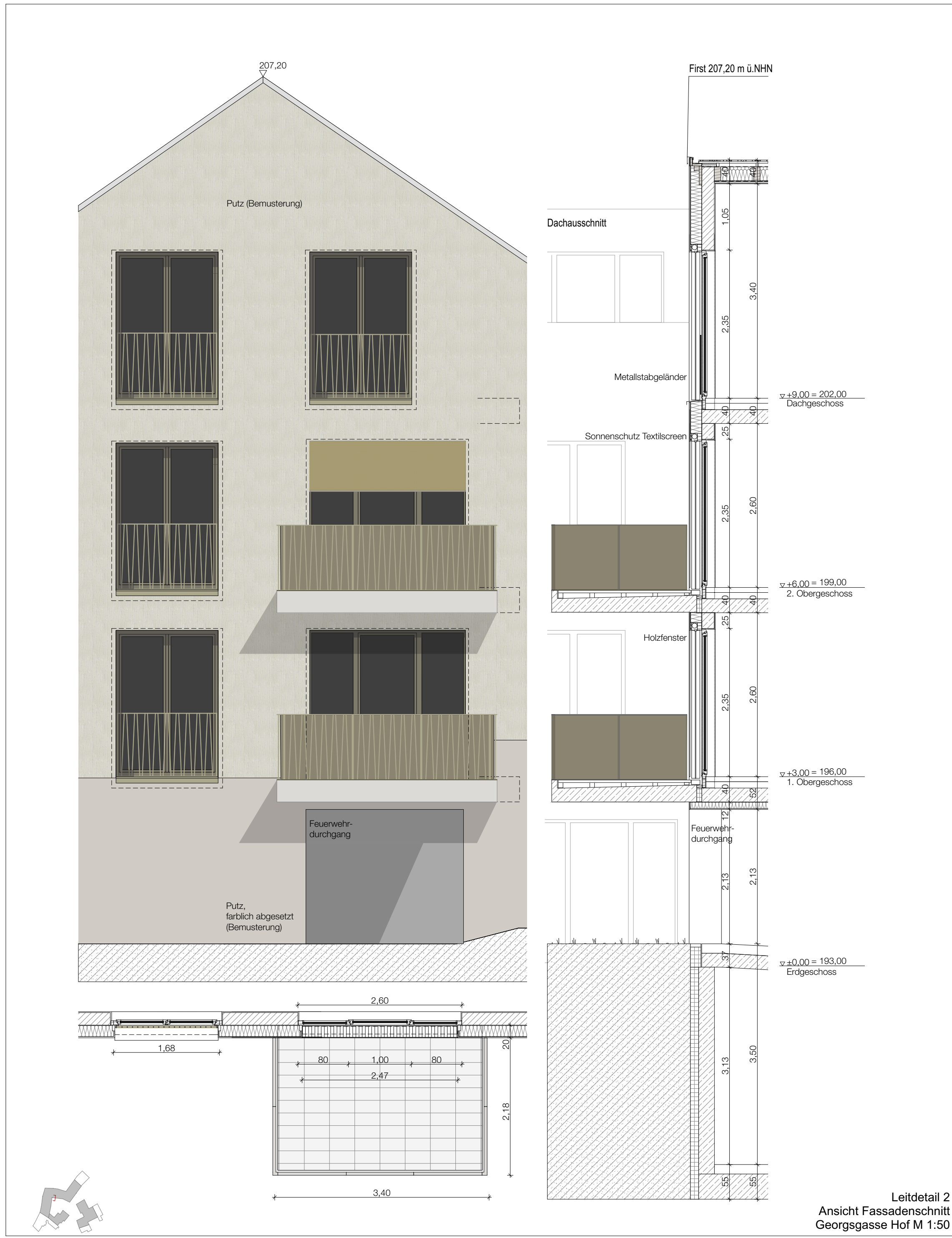
Leitdetail 1 Ansicht/ Fassadenschnitt Weiße Gasse M 1:50
