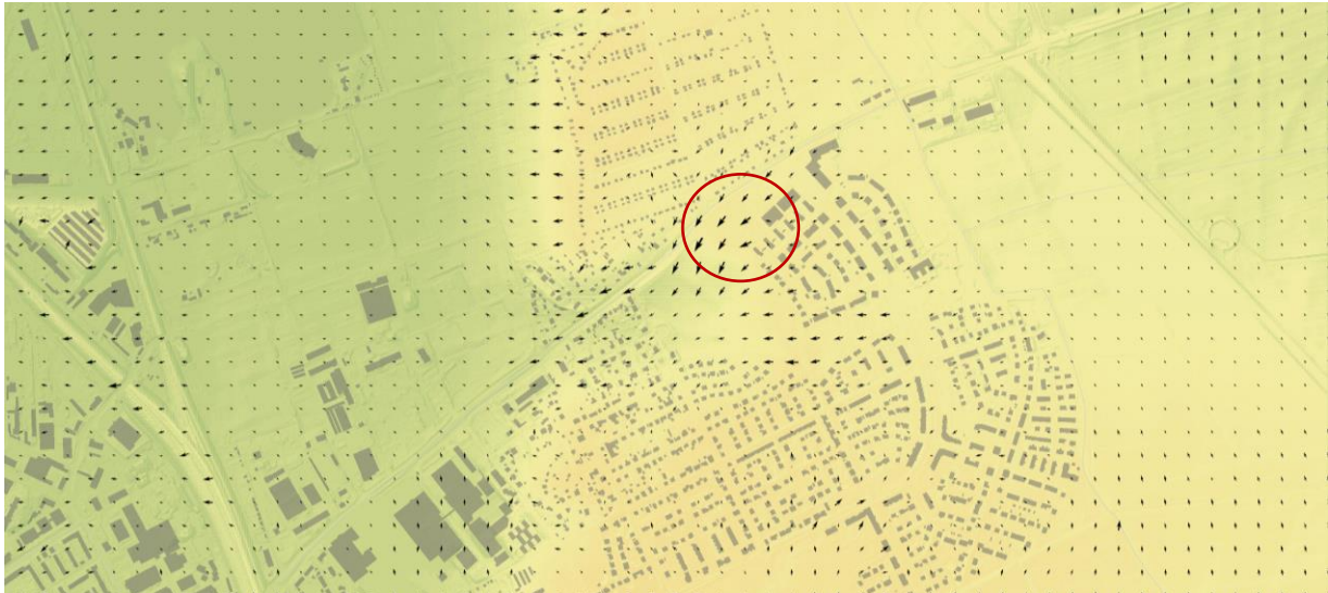
Abbildung 5: Darstellung der Abflussrichtung, dargestellt durch die Pfeilsymbole (Höhe 2m) auf dem Hintergrund des digitalen Höhenmodells.
