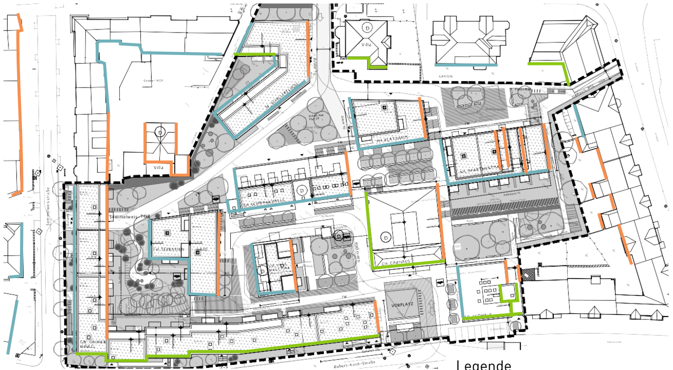
Abbildung 6.37: untersuchte Fassaden im Rahmen der Verschattungsstudie
