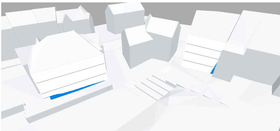
Bild 1: Besonnung östliche Nachbargebäude ohne den Neubauten des Braugoldareals am 17.01.
