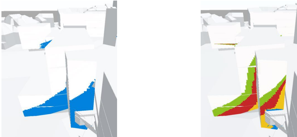
Abbildung 6.25: Besonnung Schwankhalle am 17.01. (links) und am 21.03. (rechts), Perspektive aus Westen
