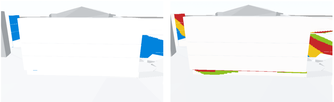
Abbildung 6.13: Besonnung Gärhaus am 17.01. (links) und am 21.03. (rechts), Perspektive aus Süden
