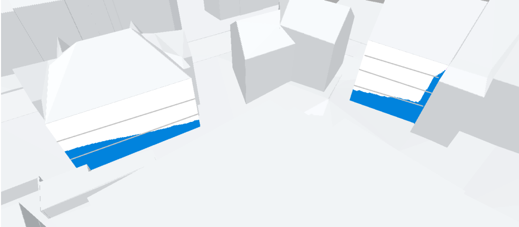
Bild 2: Besonnung östliche Nachbargebäude mit den Neubauten des Braugoldareals am 17.01.
