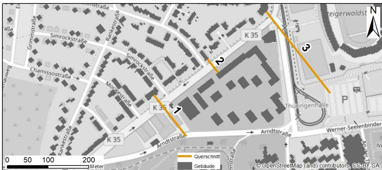
Abb. 5.1: Querschnitte 1- 3, an denen die mittlere Kaltluftfließgeschwindigkeit berechnet wurde, dunkelgraue Flächen: Gebäude im Planfall, braune Linien mit Nummer: Querschnitt mit Nummer.
