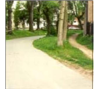
*Beispiel für die ländliche Trennung von Geh- und Fahrbahn. Die Lauflinie der Fußgänger verkürzt die Kurve und folgt den Geländebewegungen. Die Fahrlinie bildet einen gleichmäßigen Kurvenbogen mit einheitlichem Längsgefälle.*
