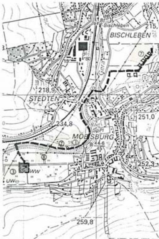
Die Stadtwerke Erfurt, Wasser GmbH verlegt im Rahmen der Komplexmaßnahme Eisenbahnüberführung (EÜ) Möbisburger Weg eine Trinkwasserleitung zwischen dem Bereich südlich der EÜ und der Geratalstraße sowie ein Steuerkabel durch den Bahnkörper von der südlichen Seite bis etwa Höhe Siedlerstraße. Der Beginn der Straßenbauarbeiten mit Verlegung der unterirdischen Kabel und Leitungen verschiedener Versorgungsträger ist für 03/98 vorgesehen.
