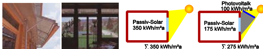
Abb.34: Die Abschattung von Fenstern durch Photovoltaikanlagen kann einen insgesamt höheren Energieverbrauch verursachen.
