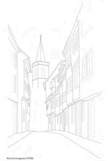
Kürschnergasse (1930) kleinteilige Parzellenstruktur Einzelhäuser geschossweise Überstände Dachrandgerinne
