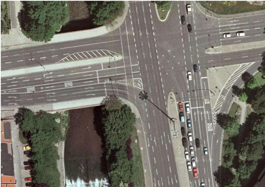
Abbildung 37: Busspuren am Knoten Schmidtstedter Brücke - Nord (Quelle: Google Maps)
