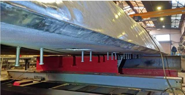
Der „rohe“ Diamant (Außensteg) in der Werkfertigung fertig verschweißt und beschliffen.
