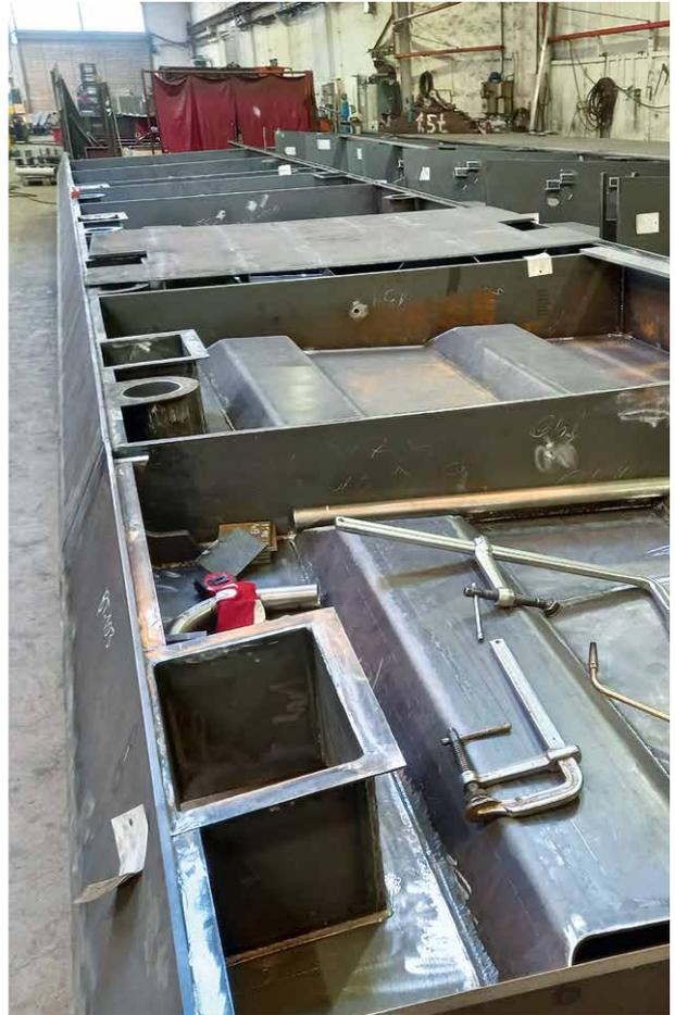
Überbau über dem Flutgraben mit erkennbaren Aussteifungen des Bodenbleches.
