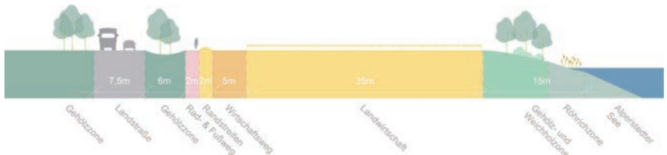
Abb. 31 Schematischer Uferschnitt mit Landstraße und landwirtschaftlicher Restfläche am Alperstedter See (Schnitt 4)
