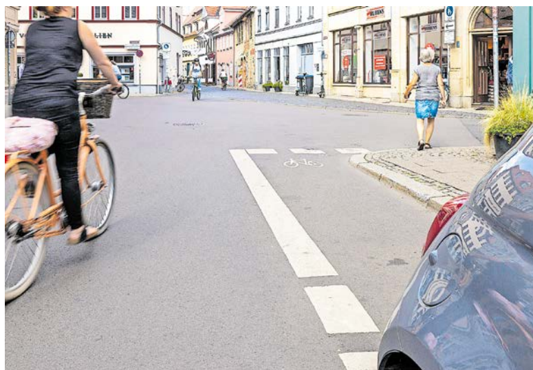
Die Aufstellfläche Lange Brücke/Paulstraße: Sie soll dafür sorgen, dass die Radfahrenden besser gesehen werden. Oft wird sie jedoch von Autos zugesperrt.
