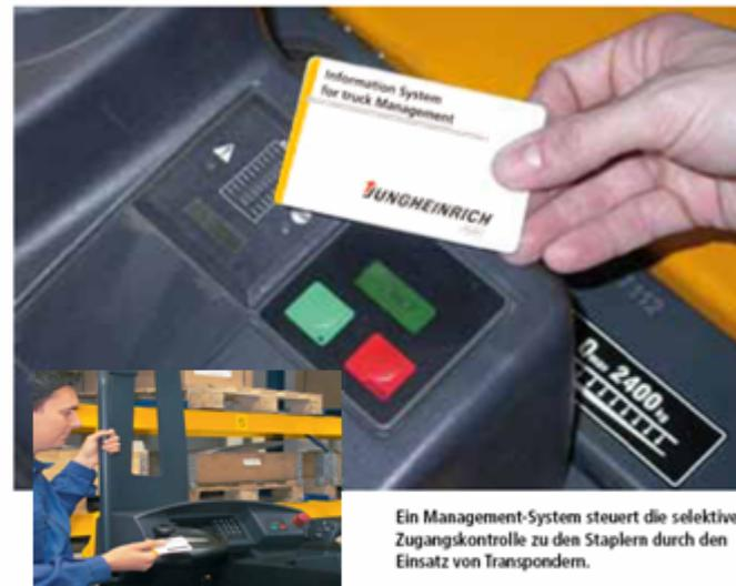
Ein Management-System steuert die selektive Zugangskontrolle zu den Staplern durch den Einsatz von Transpondern.
